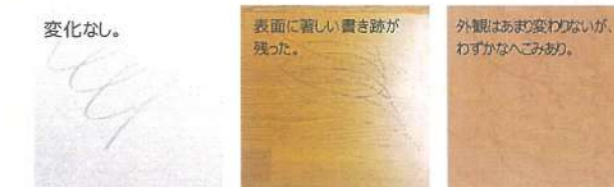
変化なし。 メラミン系カウンター 表面に著しい書き跡が残った。 集成カウンター 外観はあまり変わらないが、わずかなへこみあり。 オレフィンカウンター
