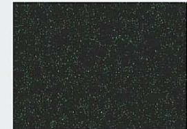
■ 塗料中の酸化チタンEDX監察結果
