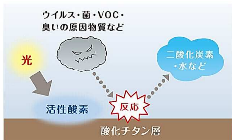
▲酸化チタンに光をあてると、活性酸素ができて 様々な物質を除去します。
